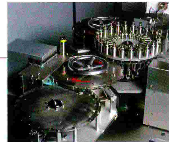
De snelle Syringe-bedrukkingsmachine van injectiespuitjes heeft een output van 500 stuks per minuut.
