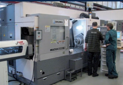
Het Multus B300-W draai/freescentrum. De machine is uitgerust met overnamespil, Ø 80 mm stafaanvoer van LNS, 60 gereedschapposities en een koelmiddeldruk van 30 bar
