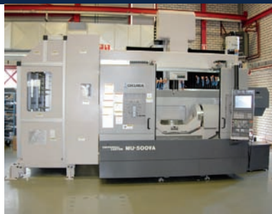
Nieuw bij AAE is het Okuma MU500VA vijf-assig bewerkingscentrum. Gecombineerd met een Erowa Heavy robot, een carrouselmagazijn en een rekmagazijn produceert machine onbemand (foto: AAE)
